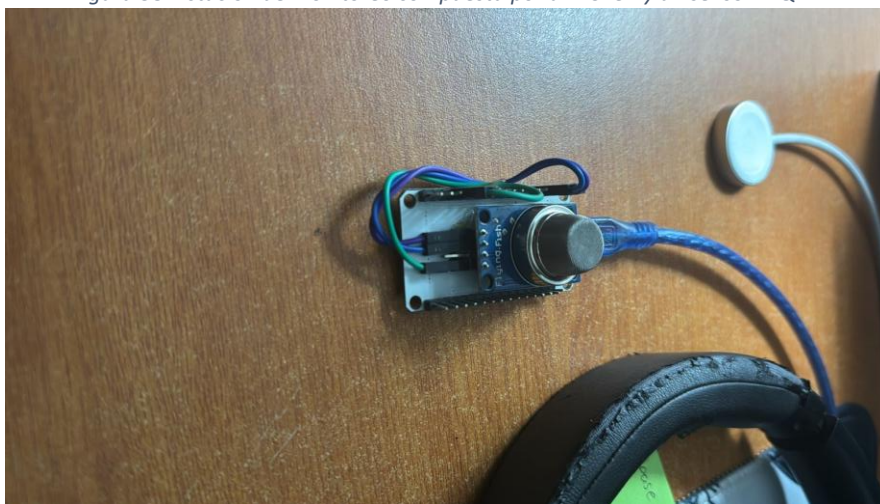
Figura 38. Estación de monitoreo compuesta por un ESP32 y un sensor MQ-4.
