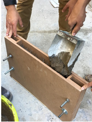
Fig. 11 Colocación mezcla en la cimbra
