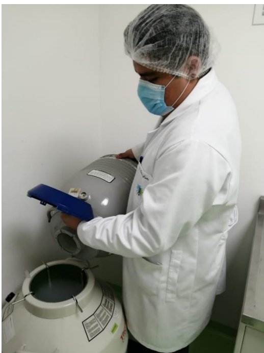
Imagen 1. Vaciado de Nitrógeno Líquido del Transportador de Nitrógeno Líquido al Tanque para Nitrógeno
