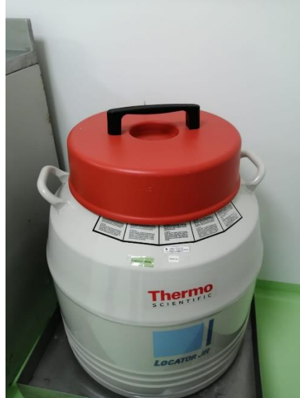
Imagen 6. Tanque para Nitrógeno
