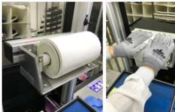
Imagen 39. Poka Yoke. Tapete pegajoso para eliminar partículas de guantes de operadores.
