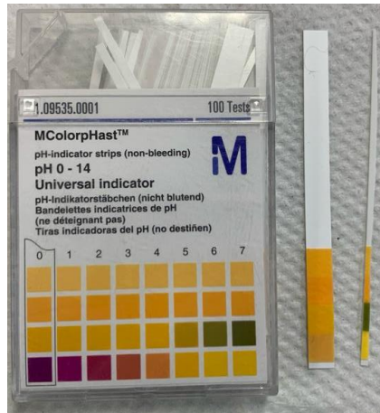
Figura 15. Ajuste de pH de las nanopartículas de oro con PBS, de un pH de 4 (Tira izquierda) a un pH de 7 (Tira derecha).
