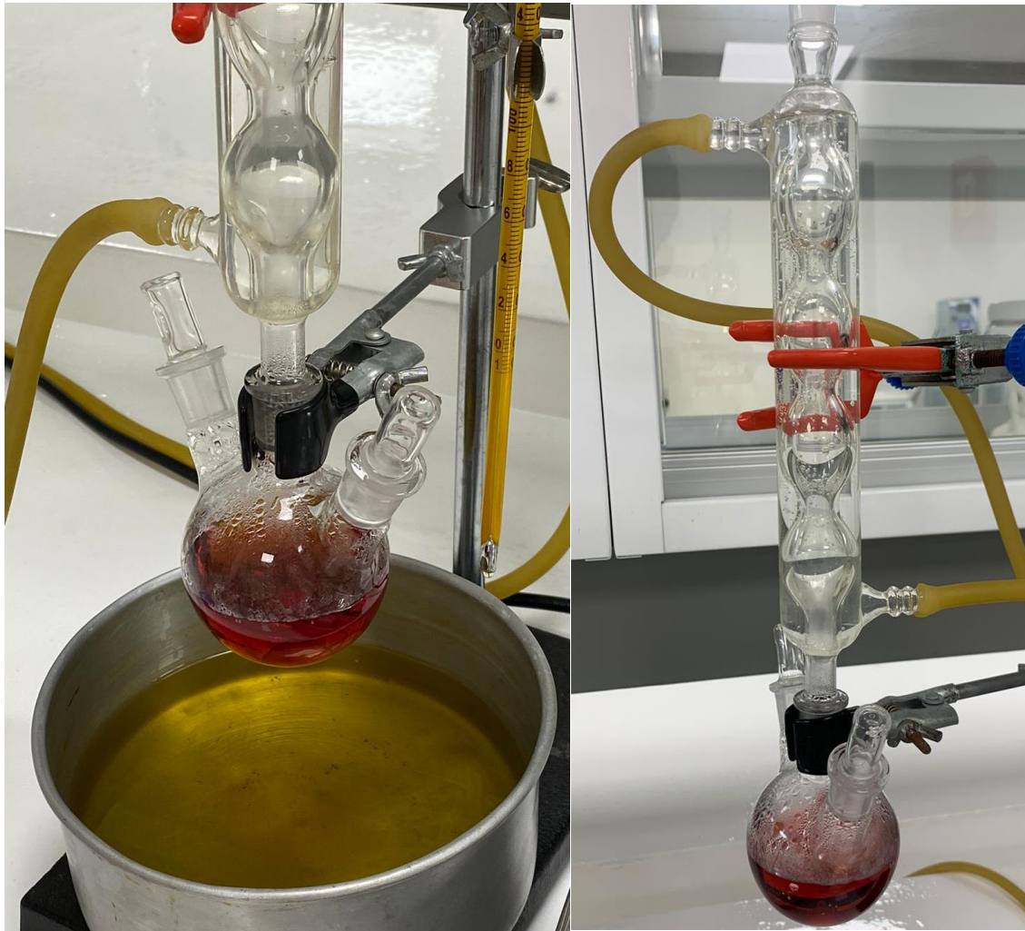
Figura 1. Montado de equipo para síntesis de nanopartículas de oro.
