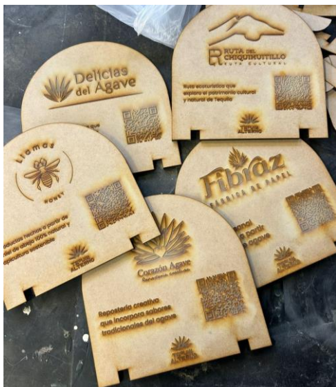
Imagen 64.1. Letreros de mdf en corte láser.
