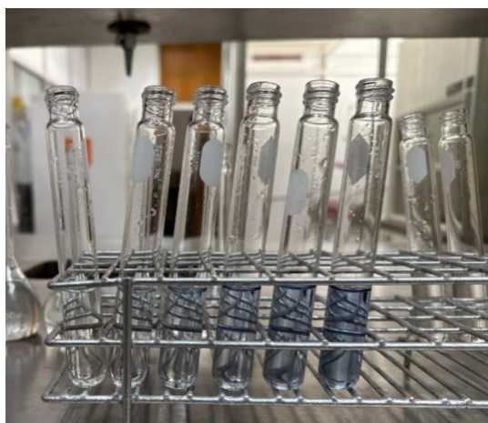
Figura 18. Reacción final para curva de calibración de ortofosfatos (0.010 – 1.5 μM), 6 estándares, sencillo.
