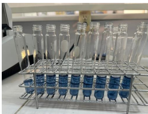
Figura 26. Reacción final para curva de calibración de ortofosfatos (2.412 – 5.100 μM), 9 estándares, sencillo.
