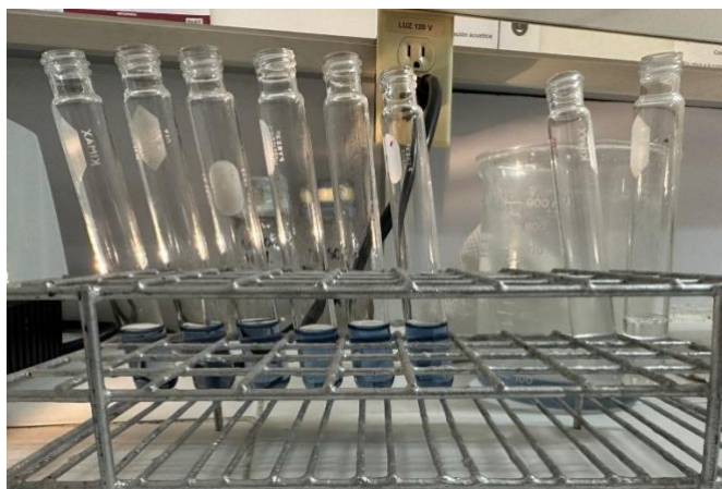
Figura 20. Reacción final para curva de calibración de ortofosfatos (1.74 – 3.42 μM), 6 estándares, sencillo.
