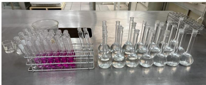
Figura 15. Reacción final para curva de calibración de nitritos ( 0.010 - 1.5 \mu\text{M} ), 7 estándares por triplicado.
