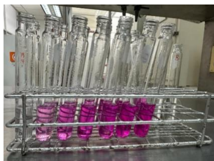
Figura 12. Reacción final para curva de calibración de nitritos (0.010 – 1.5 \mu\text{M} ), 7 estándares por duplicado.
