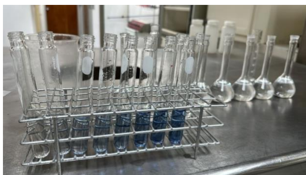
Figura 24. Reacción final para curva de calibración de ortofosfatos (0.030 – 2.412 μM), 8 estándares, sencillo.
