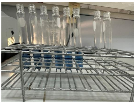
Figura 22. Reacción final para curva de calibración de ortofosfatos (3.42 – 5.10 μM), 6 estándares, sencillo.
