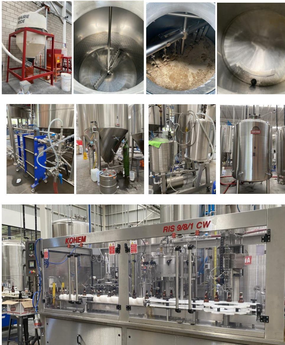
Figura 4. Proceso de la cerveza que describe etapas de a) molienda, b) maceración, c) Lauter o colado, d) cocimiento, adición de lúpulo o extracto de lúpulo y ebullición del mosto de cerveza con estos aditivos, eliminación del lúpulo gastado y de los sedimentos precipitados, e) enfriamiento del mosto con un chiller, f) fermentación con levaduras, g) filtración con perlas diatomeas, h) acondicionamiento y i) envasado.
