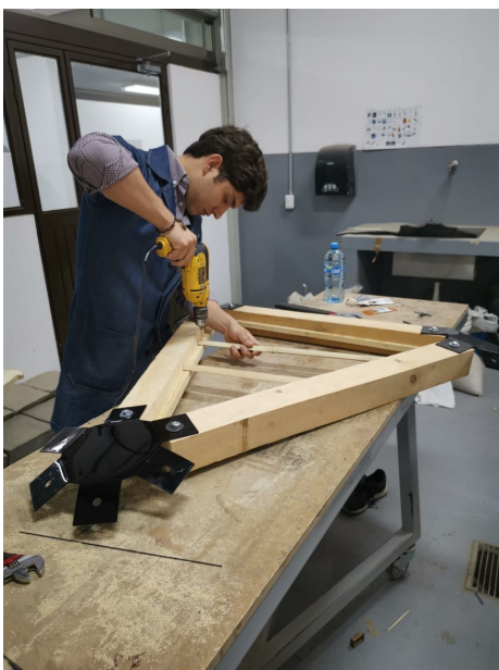
Figura 23: Anclaje de estructura de bamboo
