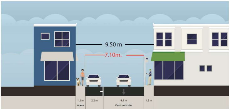
Figura 35 - Sección actual vialidad tipo 2
