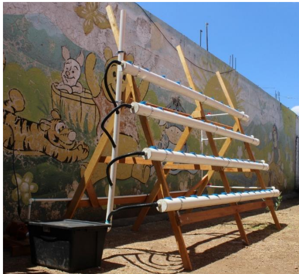
Figura 15. Unidad piloto finalizada del sistema hidropónico DFT localizado en la asociación GANA.
