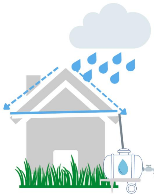
Figura 3. Sistema de Captación de Agua Pluvial
