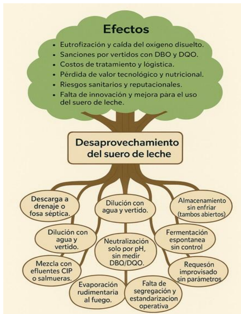
Figura 1. Árbol de problemas (causa-efecto) del manejo inicial y disposición final del suero de leche tras la elaboración del queso.
