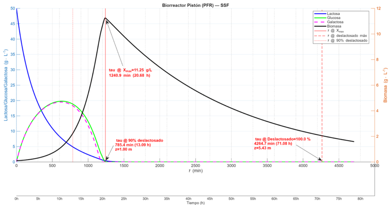
Figura 17. Esquema SSF-pistón con los valores obtenidos para deslactosado, consumo de glucosa y galactosa y crecimiento de biomasa.
