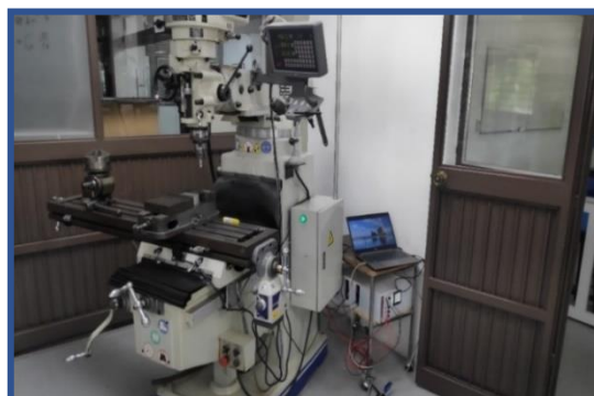
Figura 17 – Fresadora manual Aries X6325A del laboratorio de ingeniería mecánica del ITESO (Elaboración propia).
