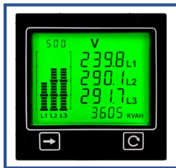
Figura 52 – Equipo de medición trifásico de voltaje, corriente y potencia real marca “true meter” (True meter, 2021).
