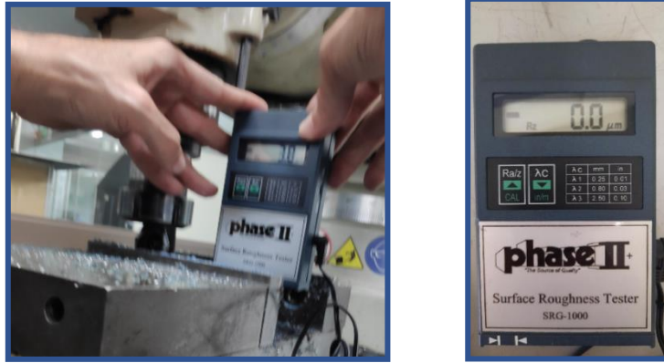
Figuras 14 y 15 – Izquierda fotografía realizando las mediciones en las piezas por parte del operador, derecha, Rugosímetro digital Phase 2 SRG-1000 con el que se realiza la medición de este parámetro de calidad. (Elaboración propia).
