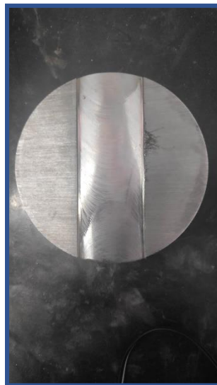
Figura 13 – Pieza de acero P20 mostrando el corte al centro de la pieza dejada por el proceso de maquinado. (Elaboración propia)
