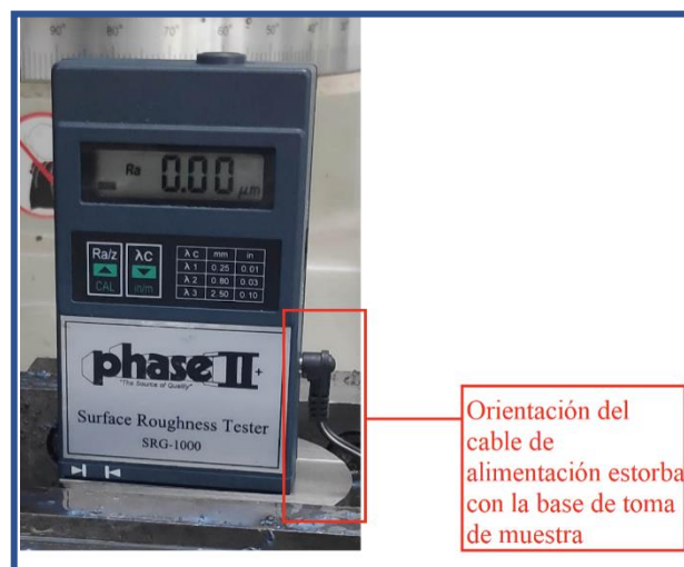
Figura 117 – Imagen de toma de muestra de rugosidad tomando con la mano el rugosímetro mientras esta toma la medición. (Elaboración propia).
