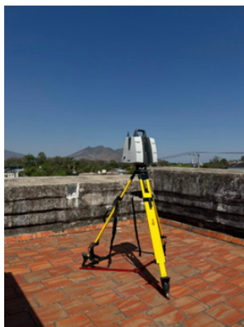
Imagen 2: Levantamiento en zona de azoteas para análisis de áreas tributarias
