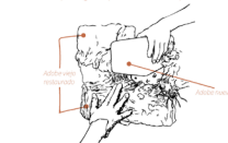
Imagen 2.6 Reemplazo de adobes con mezcla de tierra
