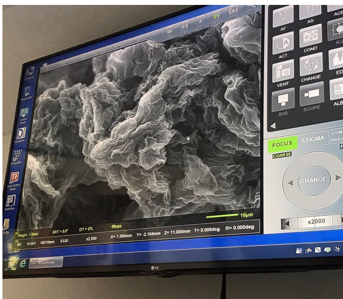
Figura 2.12: medición de nanohilos en SEM.
