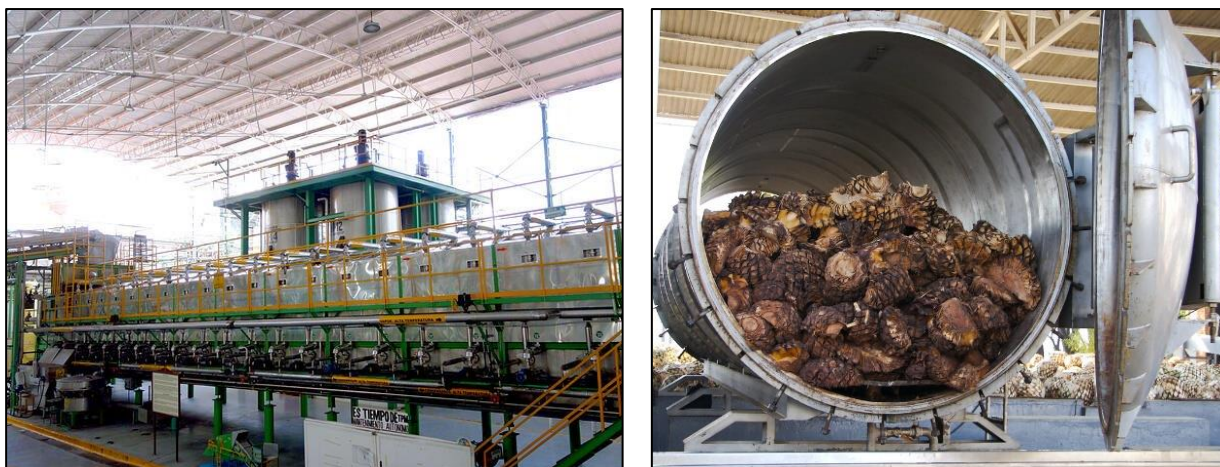
Figura 7.0, equipo difusor para extracción directa 37 y autoclave para cocción de piñas 38 .
