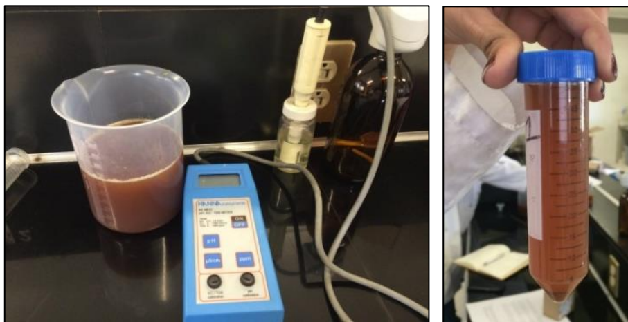
Figura 7.2, medición de pH de vinazas tequileras y en tubo de centrifugación 48 .
