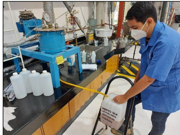
Figura 15.2, imagen de la recuperación de vinazas del alambique posterior a la destilación.
