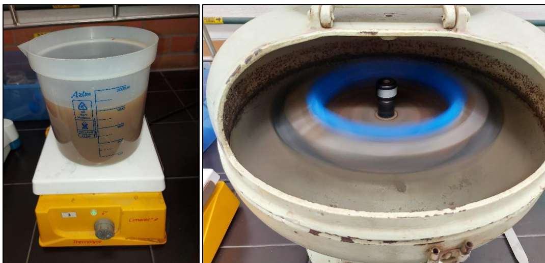
Figura 14.1, imágenes del proceso de separación, homogeneizado previo al llenado de tubos y centrifugación de mosto.
