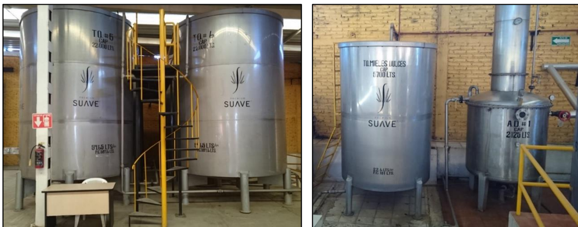
Figura 3.2, fermentadores y alambique para destilación 27 .
