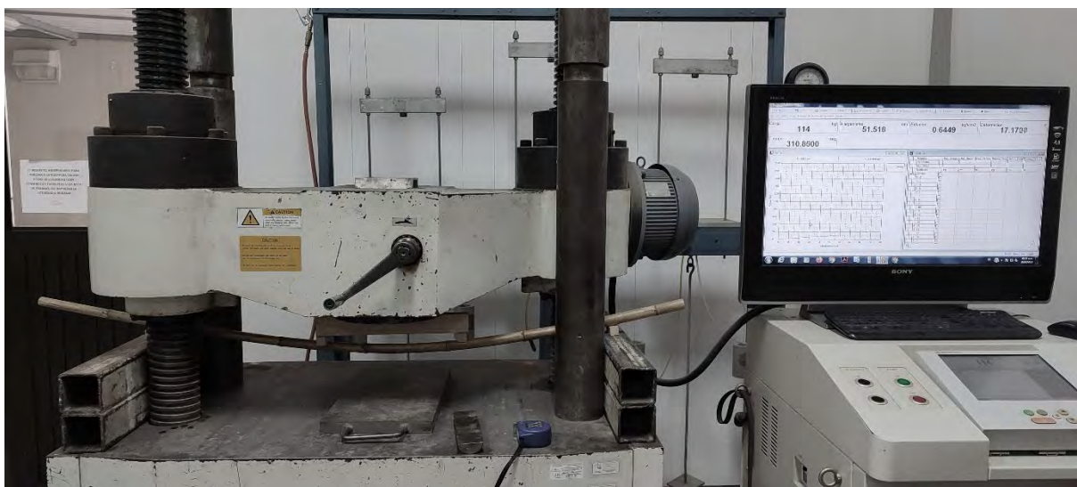
Figura 31. Ensayo de 20 piezas de Otatea acuminata a flexión.
