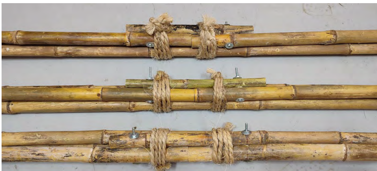
Figura 34. Unión ensayada para zunchos de Ixtle.
