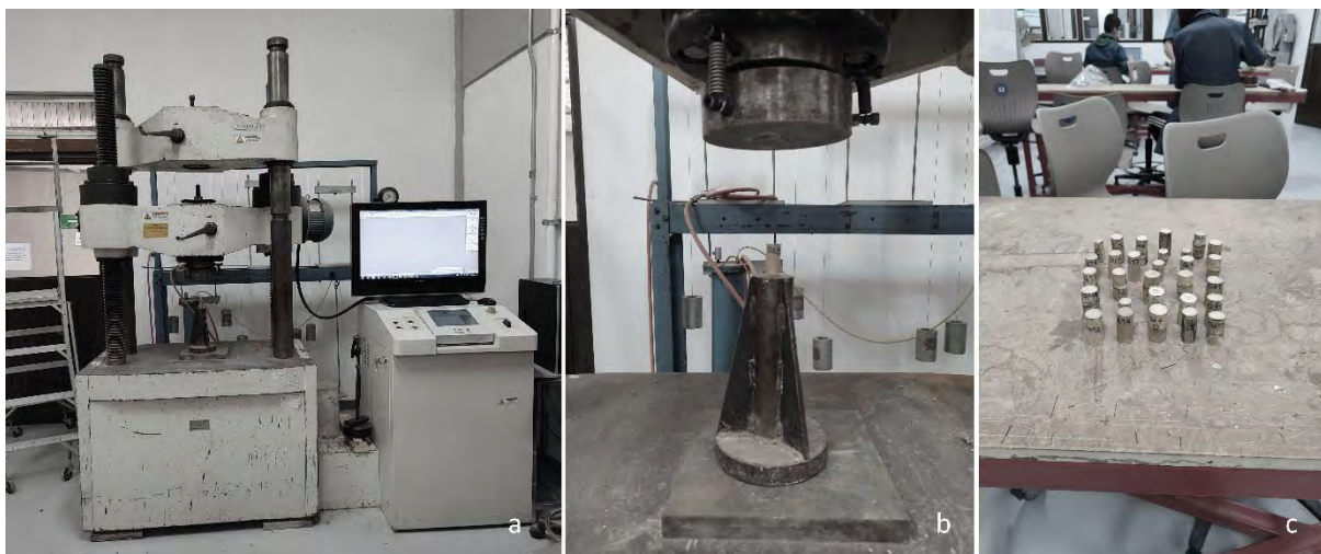
Figura 32. Ensayo de piezas de Otatea acuminata a compresión.
