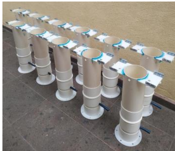
Figura 5. Pluviómetros terminados en aspecto mecánico.
