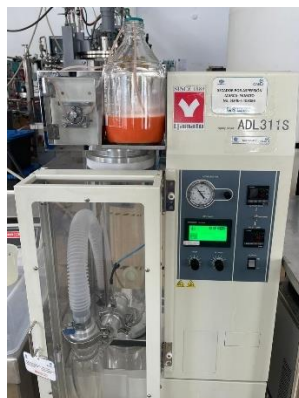
Figura 11. Secador utilizado para el secado por aspersión de la biomasa resultante de las fermentaciones.
