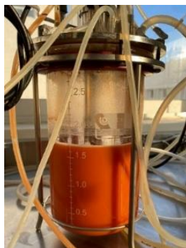
Figura 2. Biorreactor de 2 L con el MQD inoculado con X. dendrorhous .
