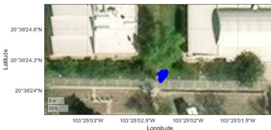
Fig. 3-15 Prueba del módulo GNSS en punto de referencia ITESO-02.
