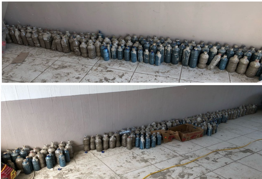
Imagen. 2. Botellas en proceso de fraguado, aproximadamente 28 día para alcanzar su máxima resistencia.
