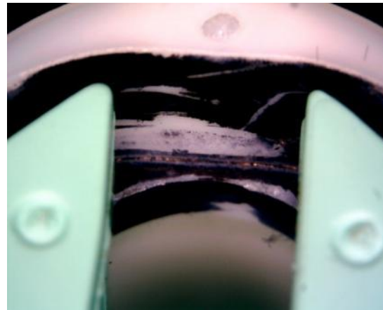
Determinación de roce entre piezas de ensamble Pisatek
