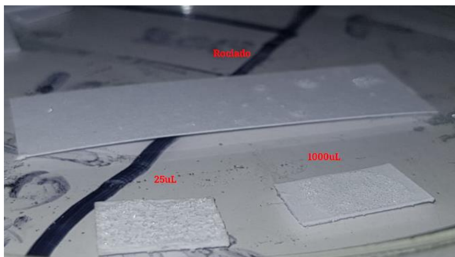
Figura 10.- Cristalización en papeles bond por diferentes métodos de deposición, a) Rociado vertical b) micropipeteo (25uL) c) micropipeteo (1000uL).
