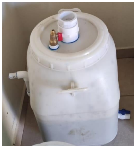
Figura 3. Prototipo de biodigestor de 50 L
