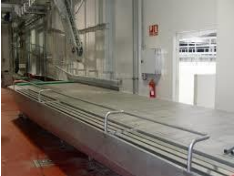
Figura 1. Mesa de sangrado horizontal para porcinos. (Imagen tomada de internet)
