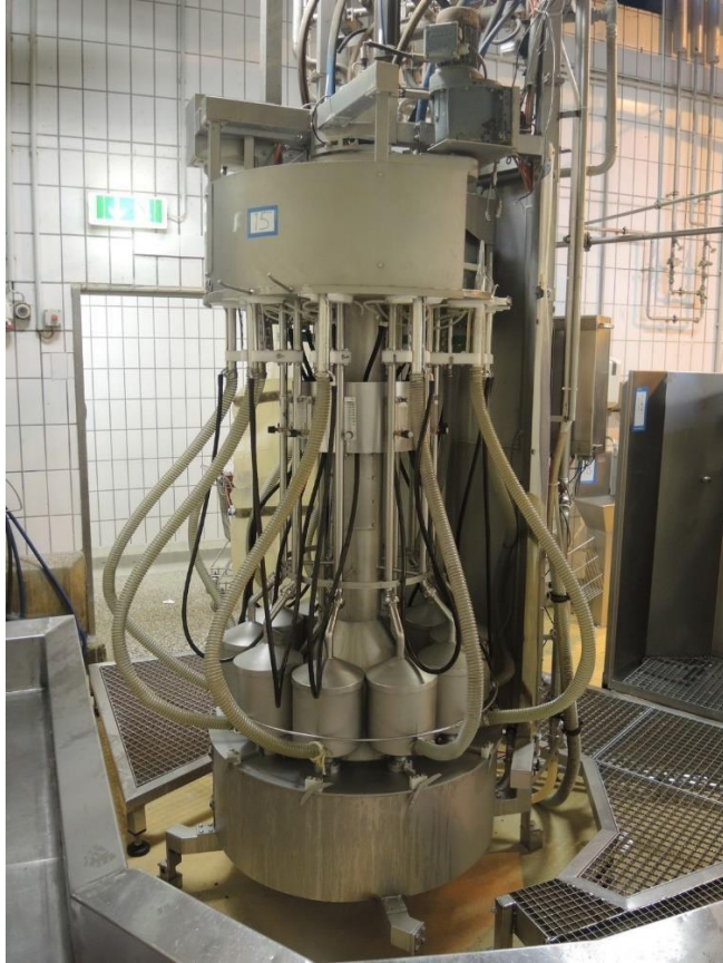
Figura 3. Sistema de recogida de sangre ANITEC en matadero. (Imagen tomada de internet)
