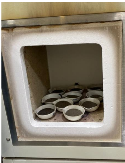
Imagen 2. Incinerado de materia orgánica en 20 crisoles con muestras
