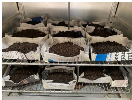
Imagen 1. Secado de muestras para evaluar el contenido de humedad en cada una.
