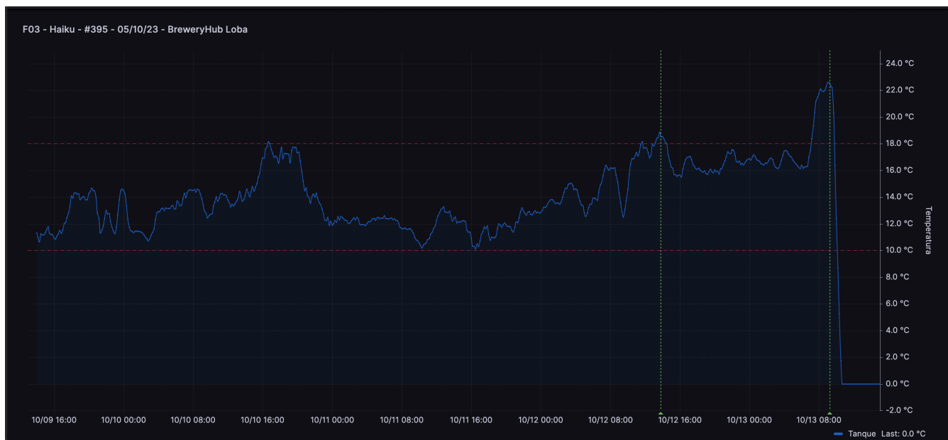
Figura 41 (Sección 4.2.2). Dashboard de Grafana Cloud del tanque de fermentación F03 (09/10/2023 - 13/10/2023). Datos registrados cada 120 segundos con media móvil ( n=6 ).
