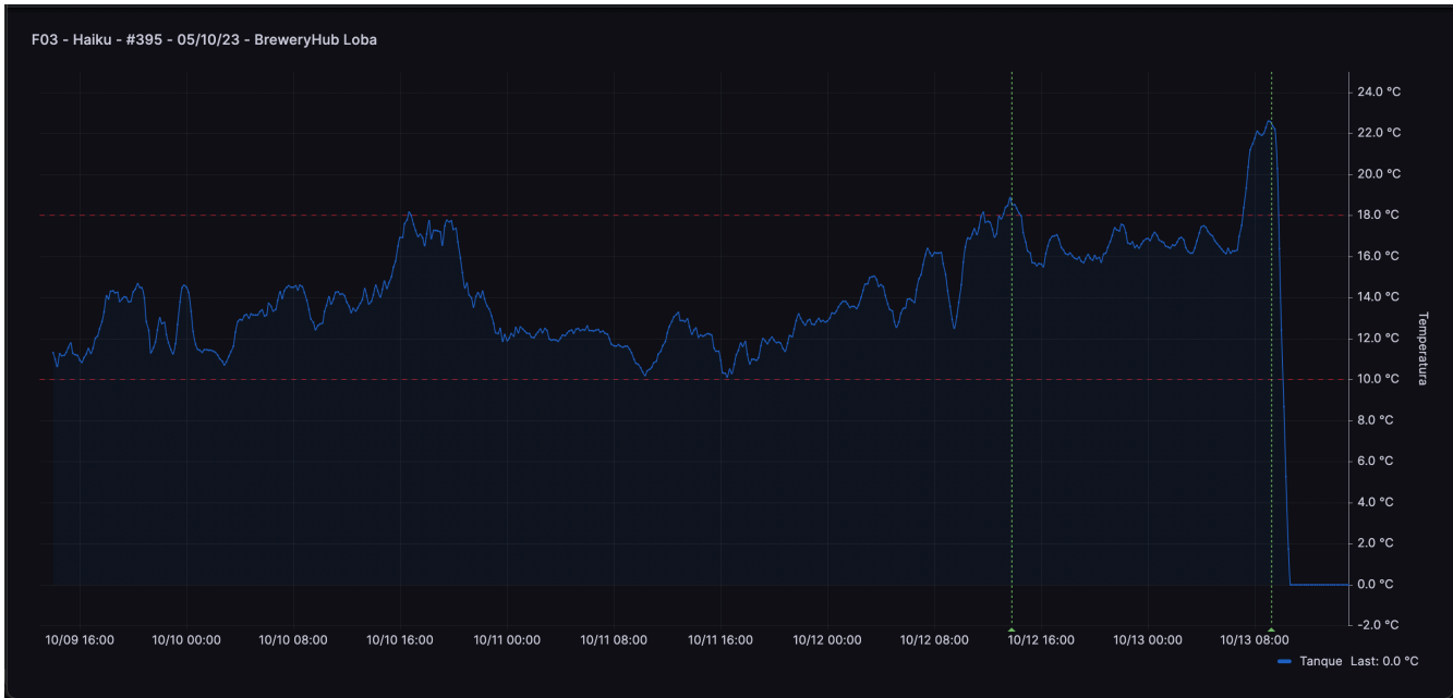
Figura 27. Dashboard de Grafana Cloud del tanque de fermentación F03 (09/10/2023 - 13/10/2023). Datos registrados cada 120 segundos con media móvil (n=6).
