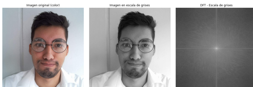
Figura 4.2: Proceso de conversión de una imagen desde su forma original (a color), a escala de grises y finalmente al dominio de la frecuencia mediante la Transformada Discreta de Fourier (DFT).
