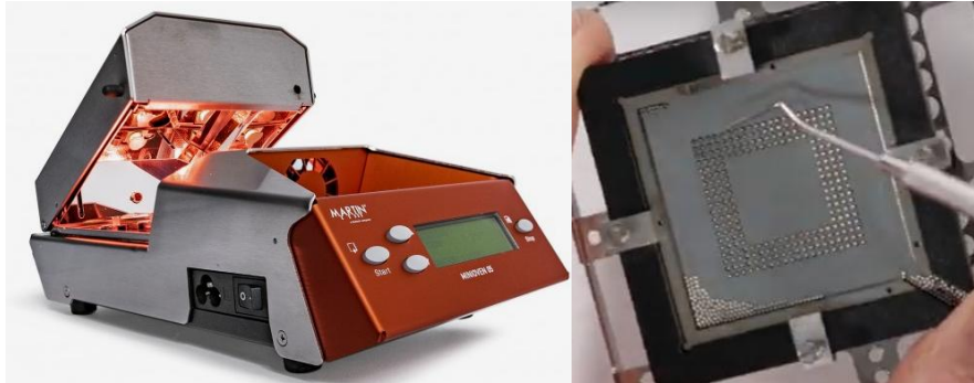
Ilustración 8 Kit de reboleo utilizando esténcil y horno infrarrojo
