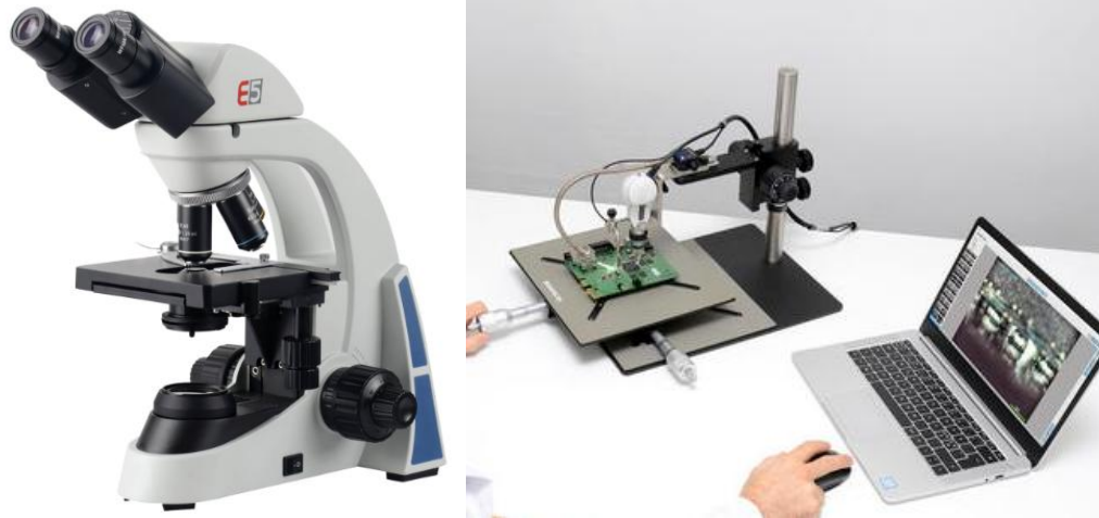
Ilustración 3 Microscopio y cámara de inspección. Herramienta utilizada para inspección óptica en análisis de fallas.
