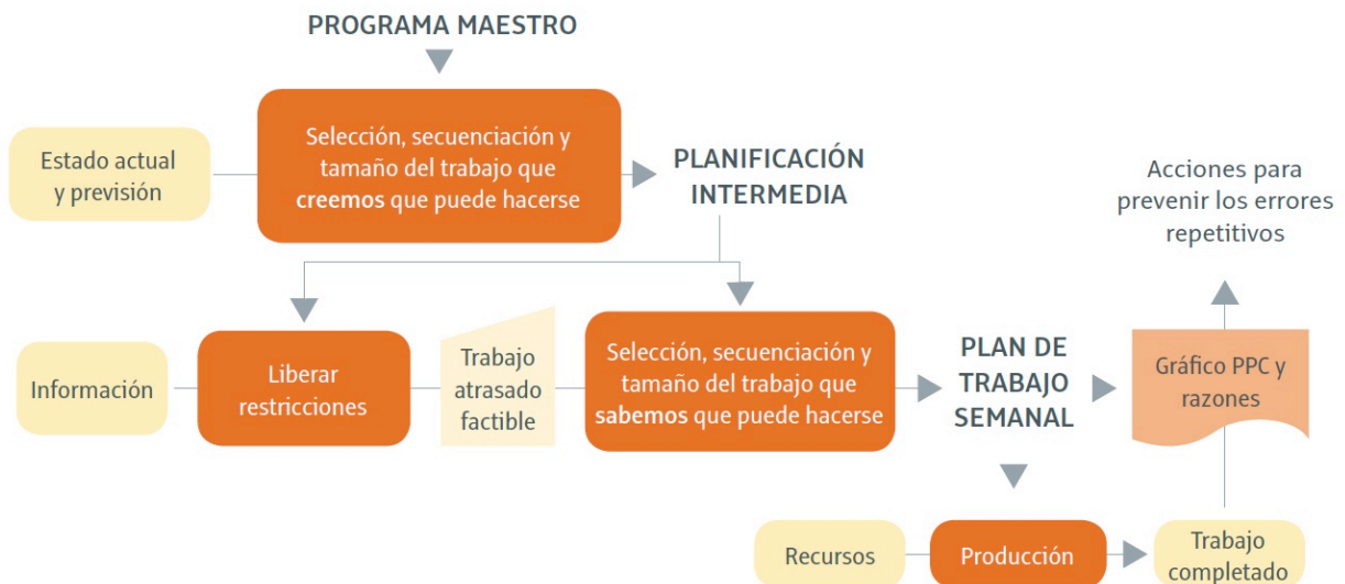
Figura 5.7. Modelo general de planificación de un proyecto usando LPS (Ballard, 2000).
