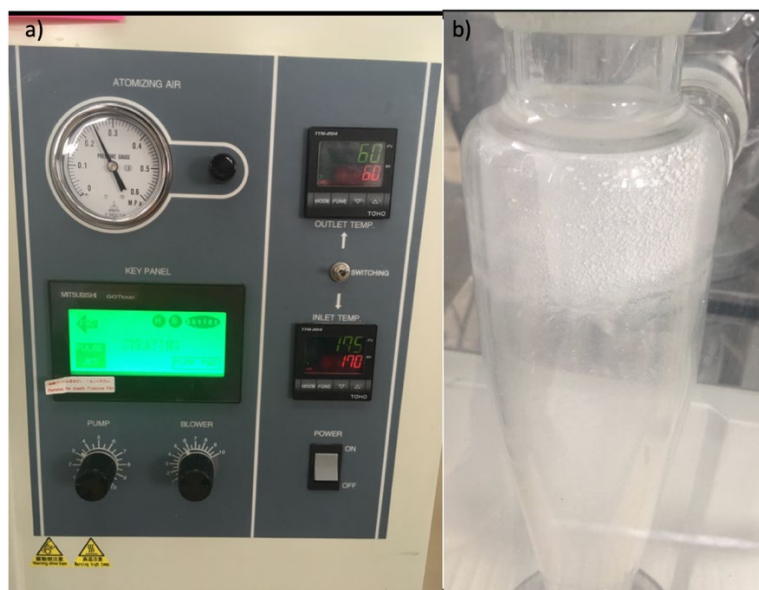
Figura 2.13 a) Parámetros de secado. b) Formación de nanocápsulas de compuesto bioactivo en polvo durante el proceso de secado por aspersión.
