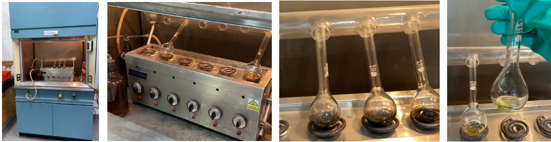
Imagen 7. Método Kjeldahl: Digestión ácida.
