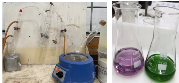
Imagen 8. Método Kjeldahl: Destilación y Titulación.
