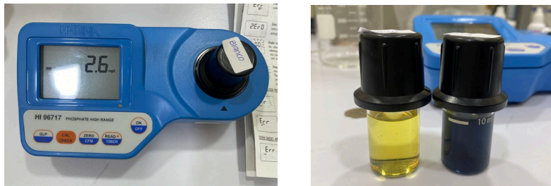
Imagen 9. Medición fosfatos con equipo HANNA HI 96717.
