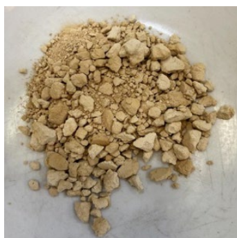
Imagen 15. Fertilizante químico compuesto por estruvita a partir de vinaza cruda.
