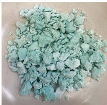
Imagen 28. Fertilizante químico compuesto por estruvita a partir de digesto.
