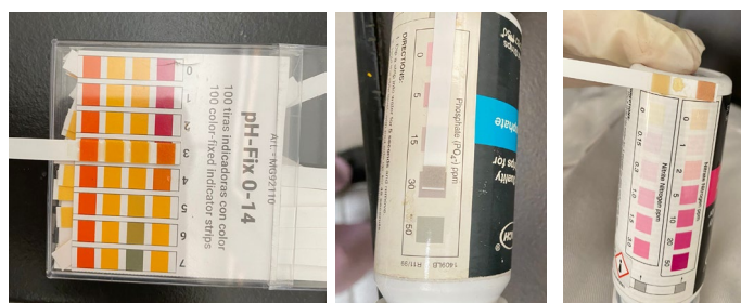
Imagen 6. Medición de pH, nitritos y nitratos con tiras reactivas.
