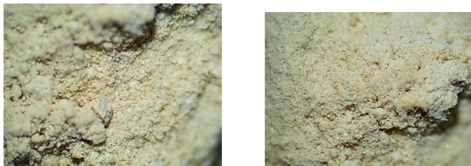
Imagen 21, 22. Fotografías del fertilizante químico compuesto por estruvita a partir de vinaza cruda.
