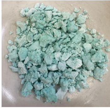
Imagen 16. Fertilizante químico compuesto de estruvita a partir de digesto.
