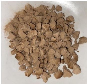
Imagen 17. Fertilizante químico compuesto de estruvita a partir de vinaza cruda con una adición de fuente de sulfato de amonio.
