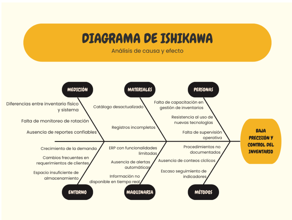
Gráfico 7 Diagrama De Ishikawa Para El Análisis De Las Causas De La Baja Precisión Y Control Del Inventario
