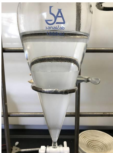
Figura 8. Sistema de solventes para HPCCC donde se observa la separación de fases inmiscibles: Upper y Lower Phase .
