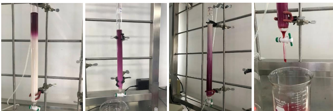
Figura 7. Purificación en columna. Fotos tomadas para ejemplificar el recorrido y retraso del pigmento de antocianinas por la columna.
