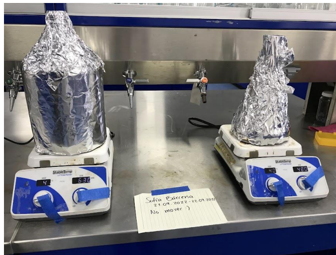
Figura 6. Muestras de cascarilla durante maceración a temperatura y agitación constante por 24 h. Los extractos fueron cubiertos con aluminio para evitar cualquier degradación de pigmento por causa de la luz.
