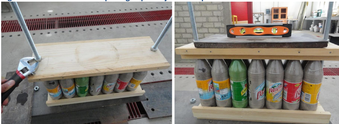
Figura 18. Colocación de espárragos para ejercer un presfuerzo.
