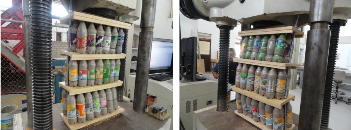
Figura 25. Comportamiento de la tercera propuesta de murete después de la prueba.
