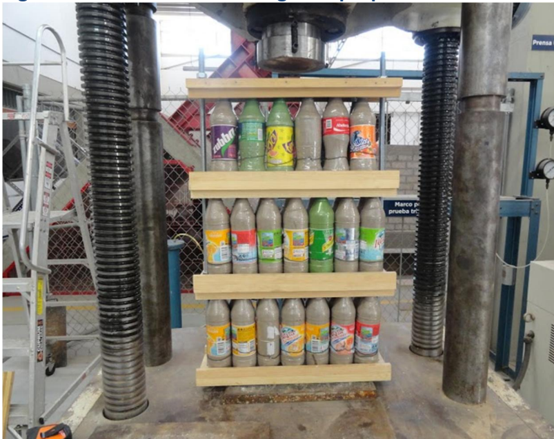
Figura 21. Configuración del murete de la segunda propuesta.
