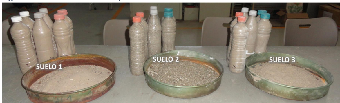
Figura A8. 4. Suelos utilizados para el relleno de las botellas.
