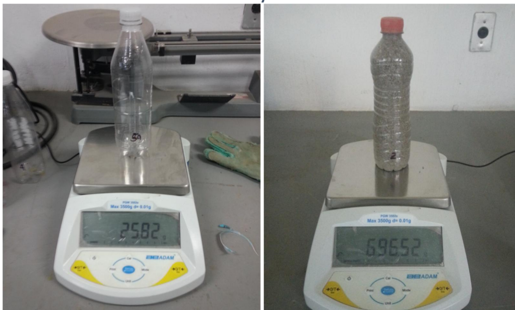
Figura A8. 8. Pesado de las botellas PET con y sin relleno.
