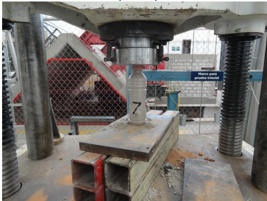
Figura 9. Colocación de la botella a ensayar en la prensa universal.
