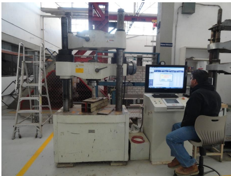
Figura A8. 5. Prensa universal del laboratorio de Ingeniería Civil, ITESO.
