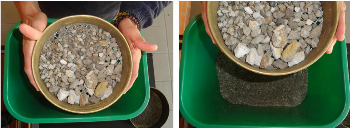
Figura A8. 6. Cribado del Jal (SW)g Arena bien graduada con grava
