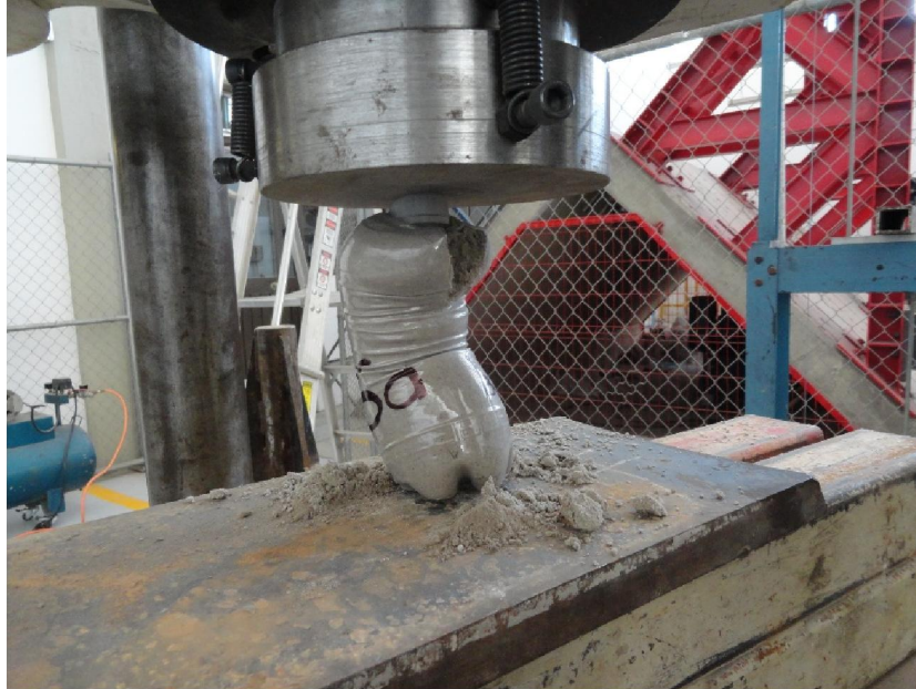
Figura A8. 11. Falla del material, debido a la carga aplicada.
