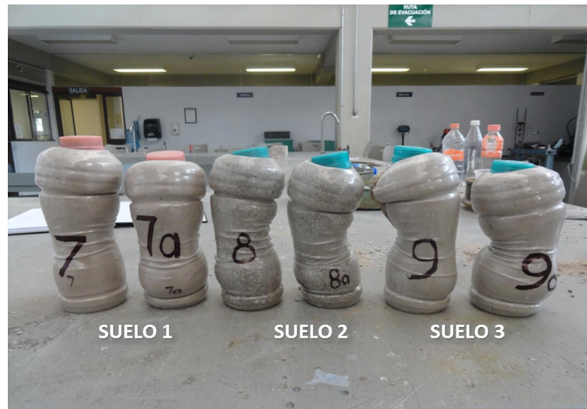
Figura A8. 15. Comportamiento de las botellas de 0.60 mm de espesor después de la prueba.
