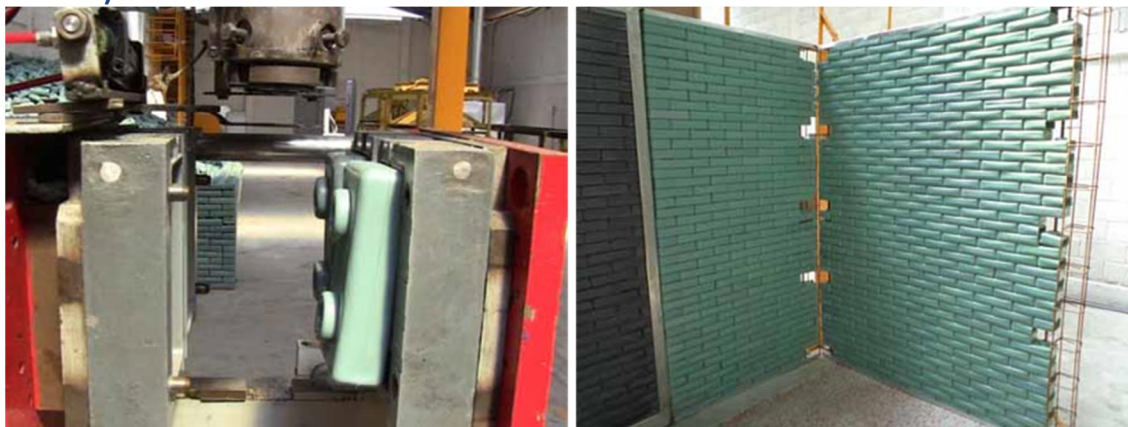
Figura 4. Moldeado y armado del sistema constructivo Cero's (ladrillos de PEAD reciclado).
