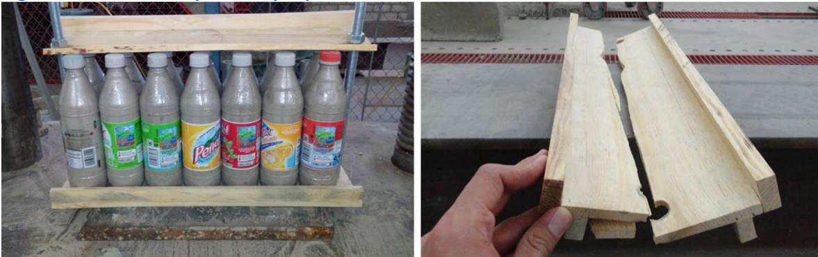
Figura 20. Falla de la primera propuesta de murete.
