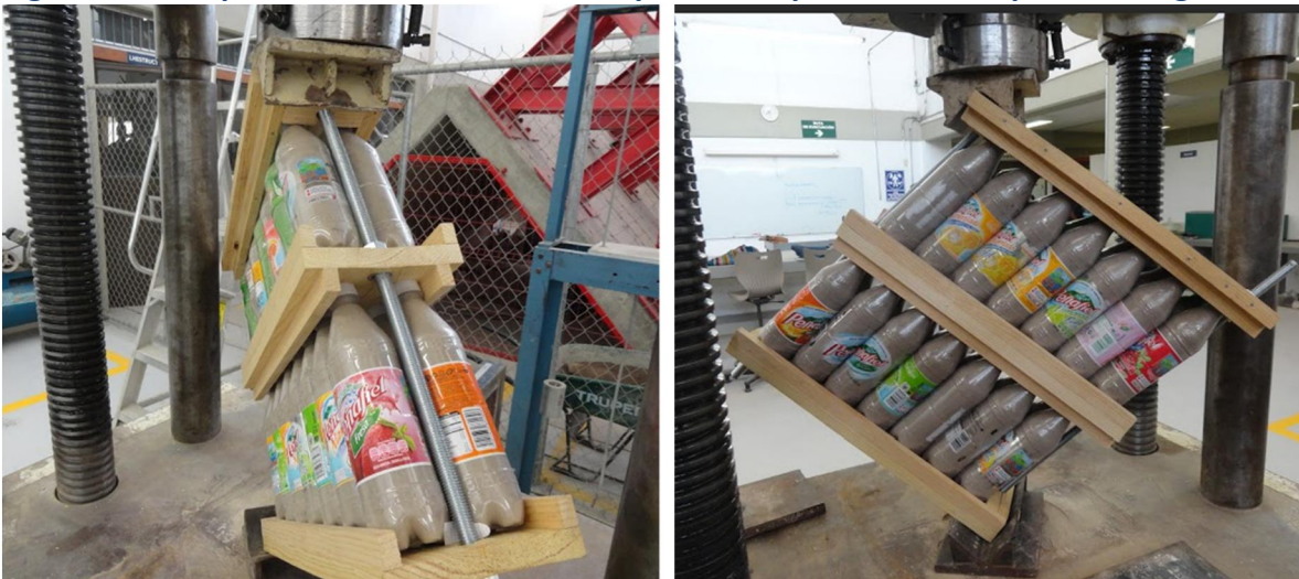
Figura 23. Comportamiento del murete después de la prueba de compresión diagonal.
