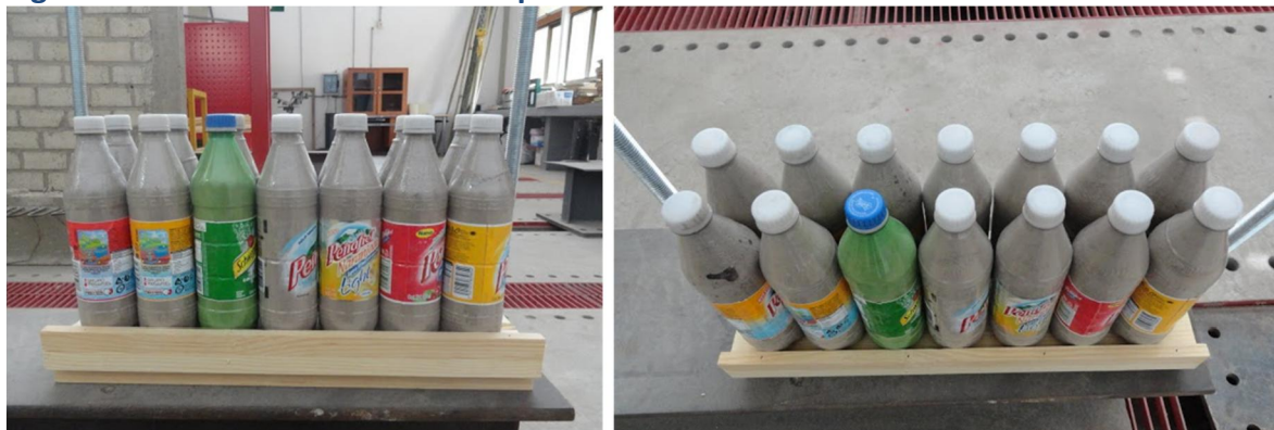
Figura 17. Acomodo de las botellas para la conformación de muros.
