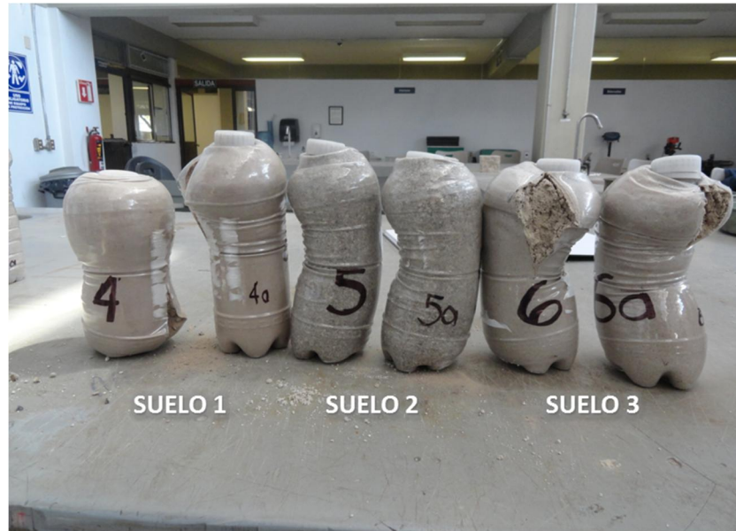
Figura A8. 14. Comportamiento de las botellas de 0.45 mm de espesor después de la prueba.
