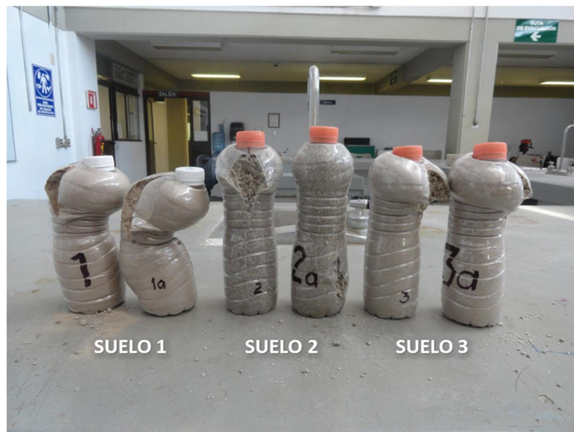
Figura A8. 13. Comportamiento de las botellas de 0.25 mm de espesor después de la prueba.
