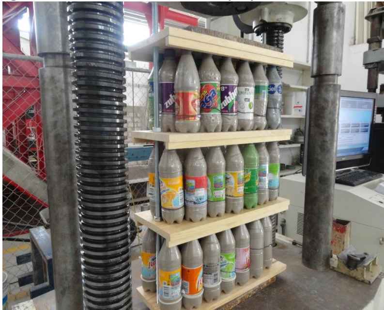
Figura 24. Configuración del murete de la tercera propuesta.
