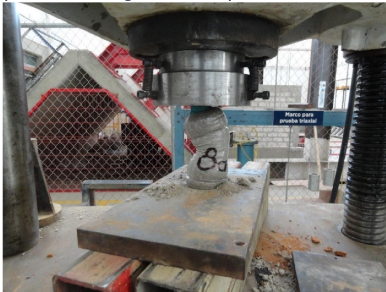
Figura A8. 10. Aplicación de la carga vertical al espécimen.
