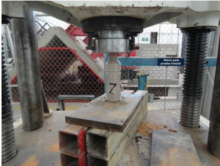
Figura A8. 9. Colocación de la botella a ensayar en la prensa universal.
