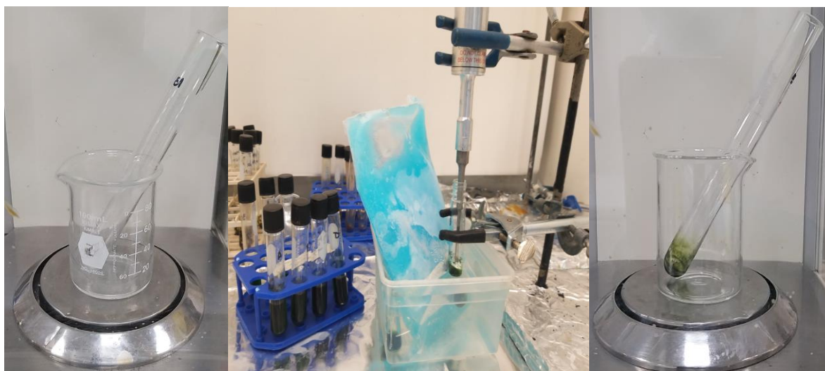
Figura 3. Montaje para la sonicación de extractos.
