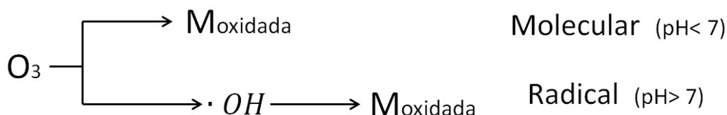
**Figura 7.** Diagrama general del sistema de reacción del ozono por ambas vías (Arenas-Cárdenas, 2015)
