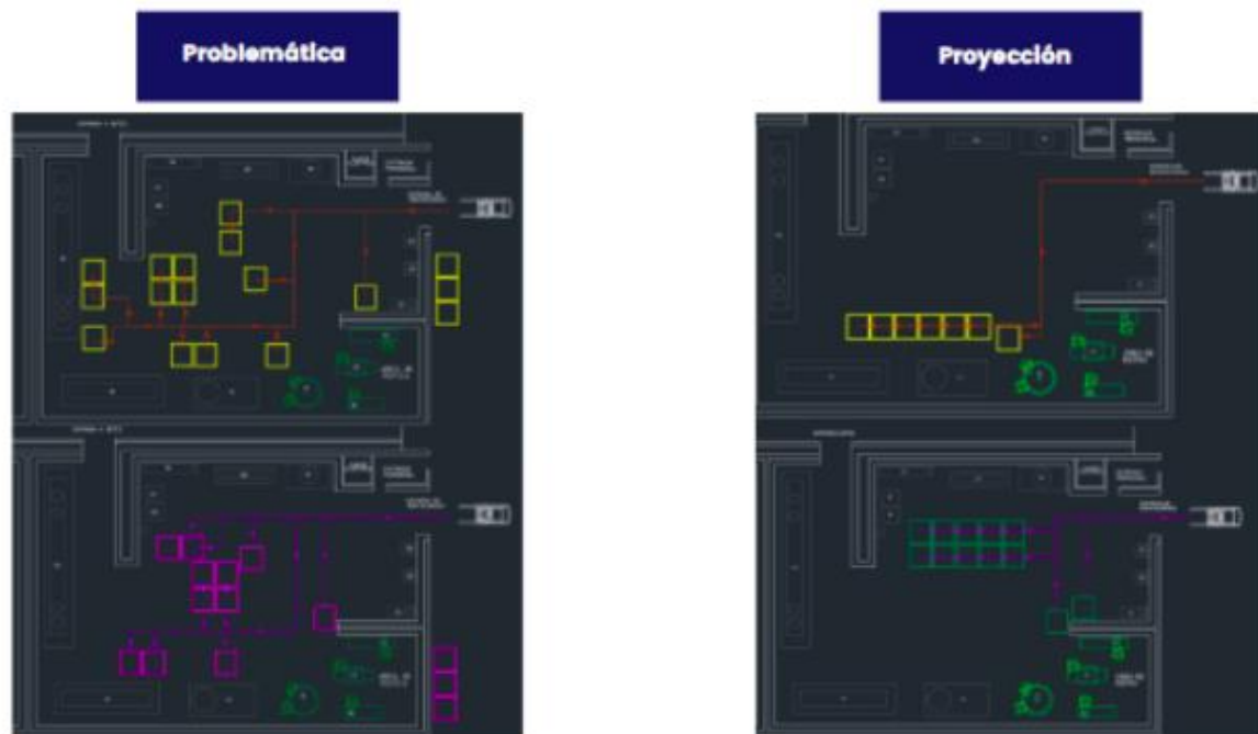
imagen 3. planos de la distribución de la planta antes y después Elaborado por: Oscar Madrigal
