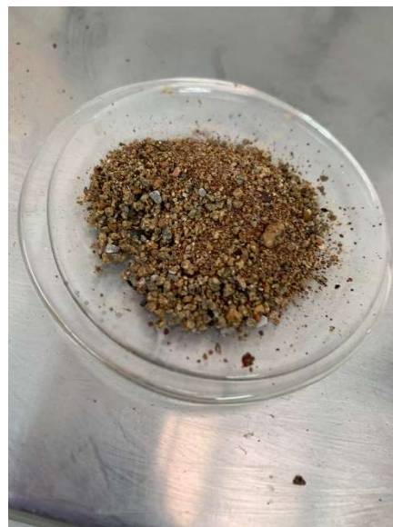
Figura 22 Remanente después del secado al horno
