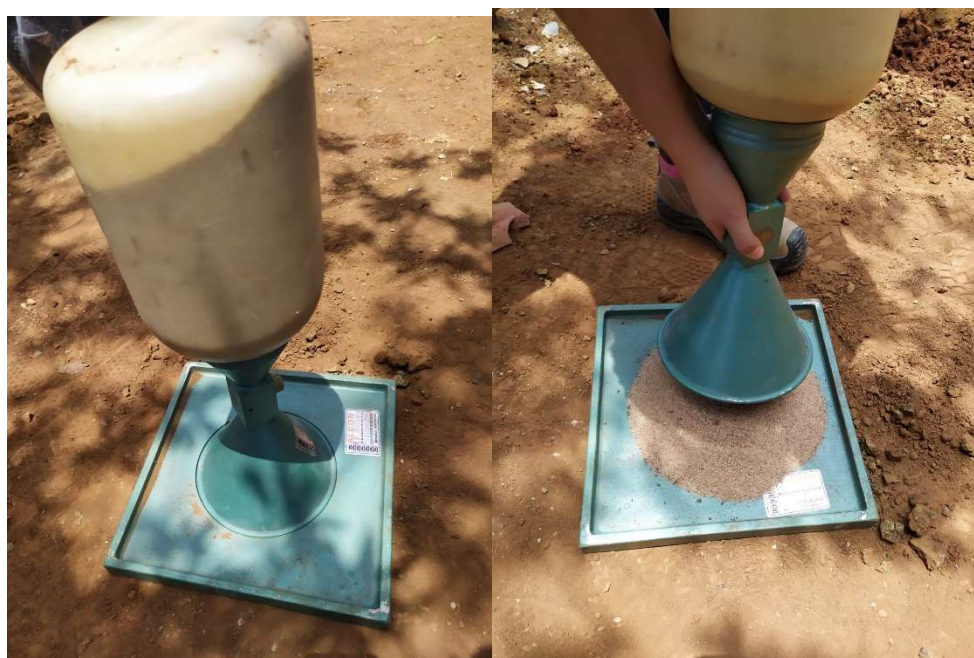
Figura 15 Vertido de arena sílica calibrada en la cala para determinar su densidad por medio del volumen del suelo extraído.
