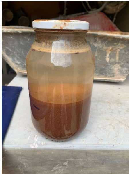
Figura 5 Sedimentación de suelo: muestra de Chiquilistlán
