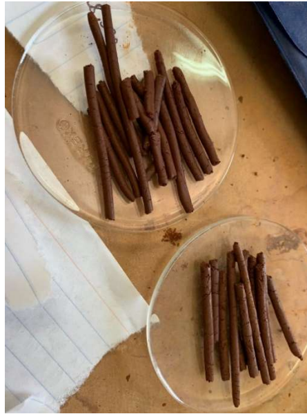
Figura 29 Muestra de limite plástico para ser secado
