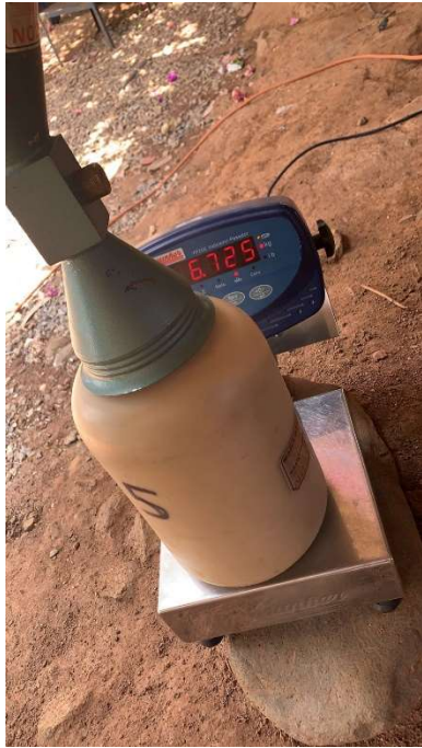
Figura 11 Peso inicial de dispositivo de cono y arena
