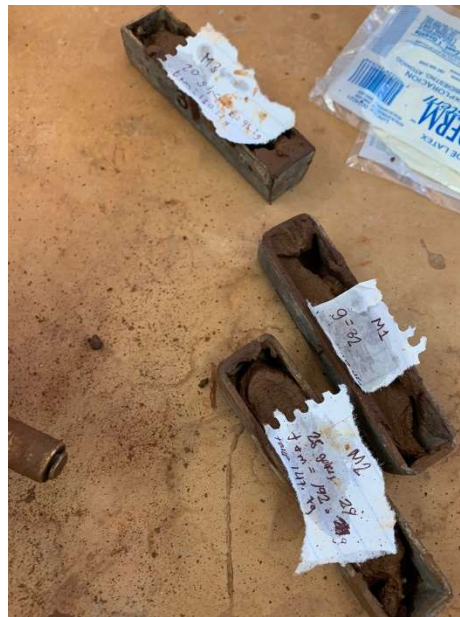
Figura 28 Muestra de limite liquido en probetas de contracción para secado
