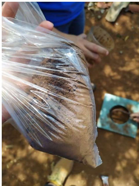
Figura 14 Material extraído para determinación del contenido de humedad in situ
