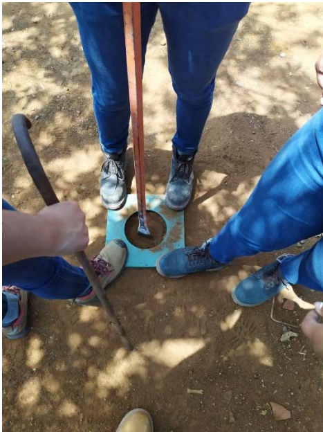
Figura 13 Extracción del suelo para formación de la cala
