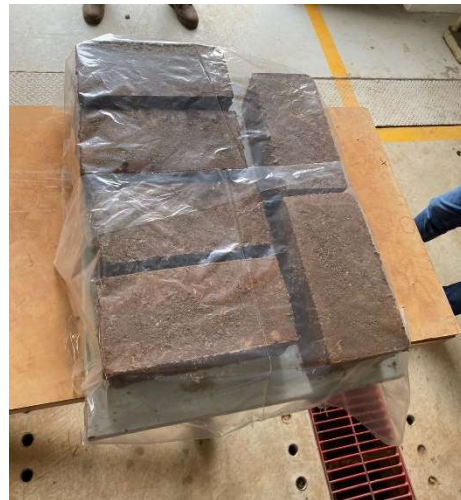
Figura 34 Especímenes elaborados con dosificación 1 y 2
