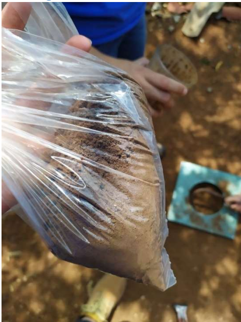
Figura 17 Extracción de muestra in situ para contenido de humedad
