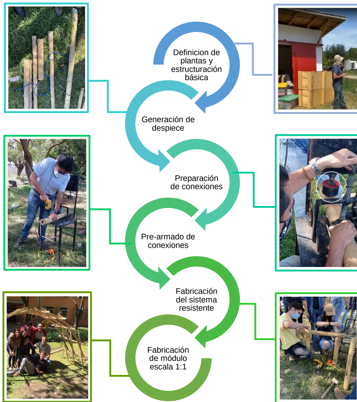
Ilustración 130. Desglose del proceso constructivo, acompañado de fotografías de su desarrollo. Autoría propia
