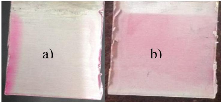
Figura 31 Resultados obtenidos del anodizado a una concentración de 1 g/L a un pH constante de 7.
