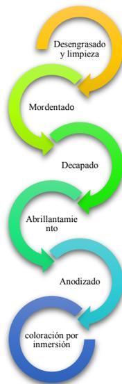
Figura 2 Ciclo de trabajo típico para el anodizado de piezas.
