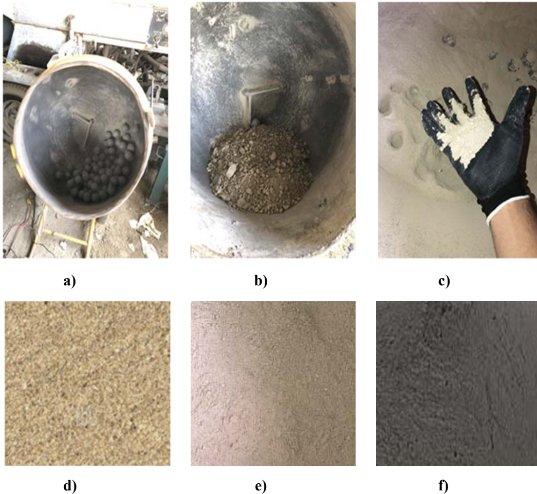
Figura 3.3. Procedimiento para molienda y materiales Puzolanicos después del proceso de cuatro horas: a) revolvedora modificada con 88 bolas de acero; b) revolvedora con material Puzolanico; c) material Puzolánico molido por dos horas; d) Jal de GDL; e) Tepetate de GDL y f) Ceniza Volcán de COL.
