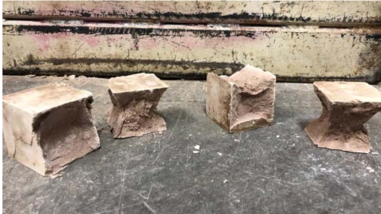
Figura 4.10. Mecanismo de falla cónica encontrada en la mayoría de los especímenes con 28 días de endurecimiento.
