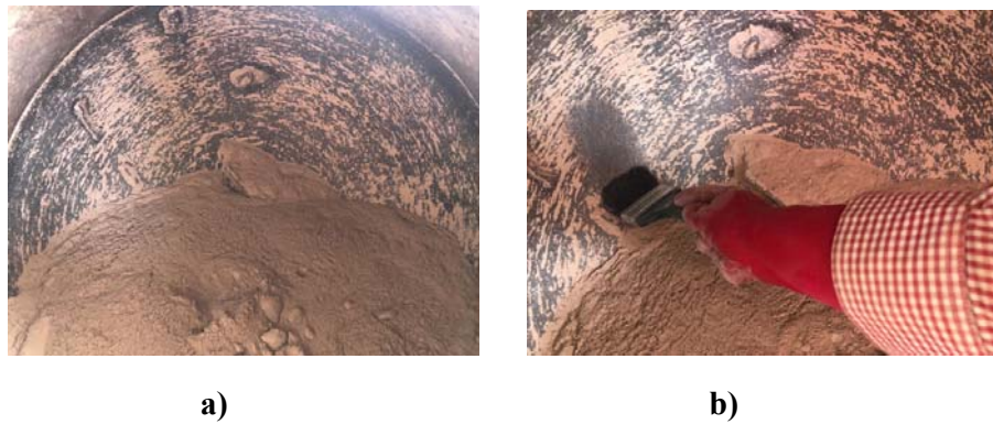
Figura 4.2. Molienda de material seleccionado: a) material adherido en las paredes de la revoladora por un lapso de una hora y b) limpieza del mismo para asegurar una trituración adecuada.
