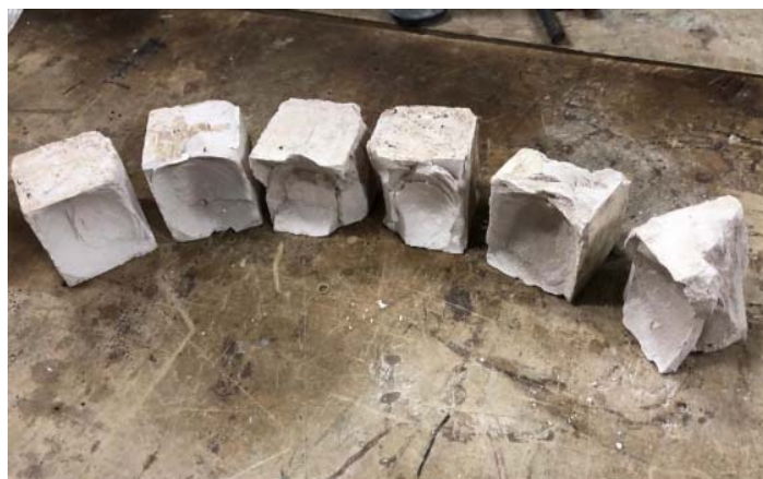
Figura 4.11. Mecanismo de falla cónica encontrada en la mayoría de los especímenes con 90 días de endurecimiento.
