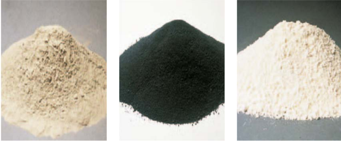
Figura 2.5. Partículas de Pozzolanas artificiales comúnmente utilizadas en el desarrollo de conglomerantes hidráulicos alternativos al cemento Portland: a) ceniza volante; b) humo de sílice y c) metacaolín (Kosmatka et al. , 2003).
