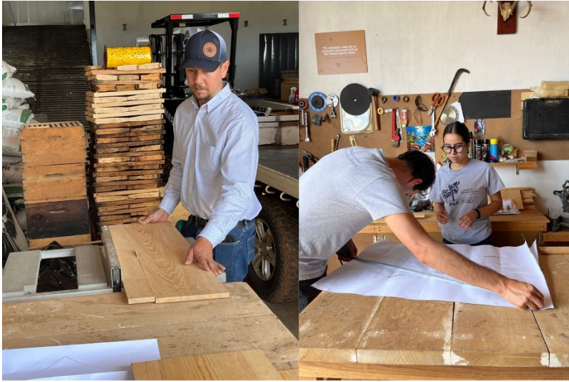
Figura 18. Proceso de trazado y corte de mesa modular hexagonal.
