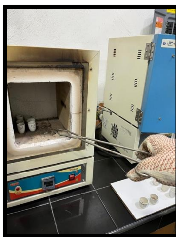
Figura 6. Colocación de crisoles en la mufla para determinar cenizas.
