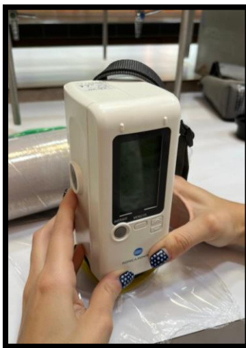
Figura 9. Colorímetro utilizado para la determinación de color en las muestras de suelo.
