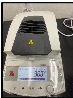
Figura 2. Termobalanza utilizada para determinar porcentaje de humedad.
