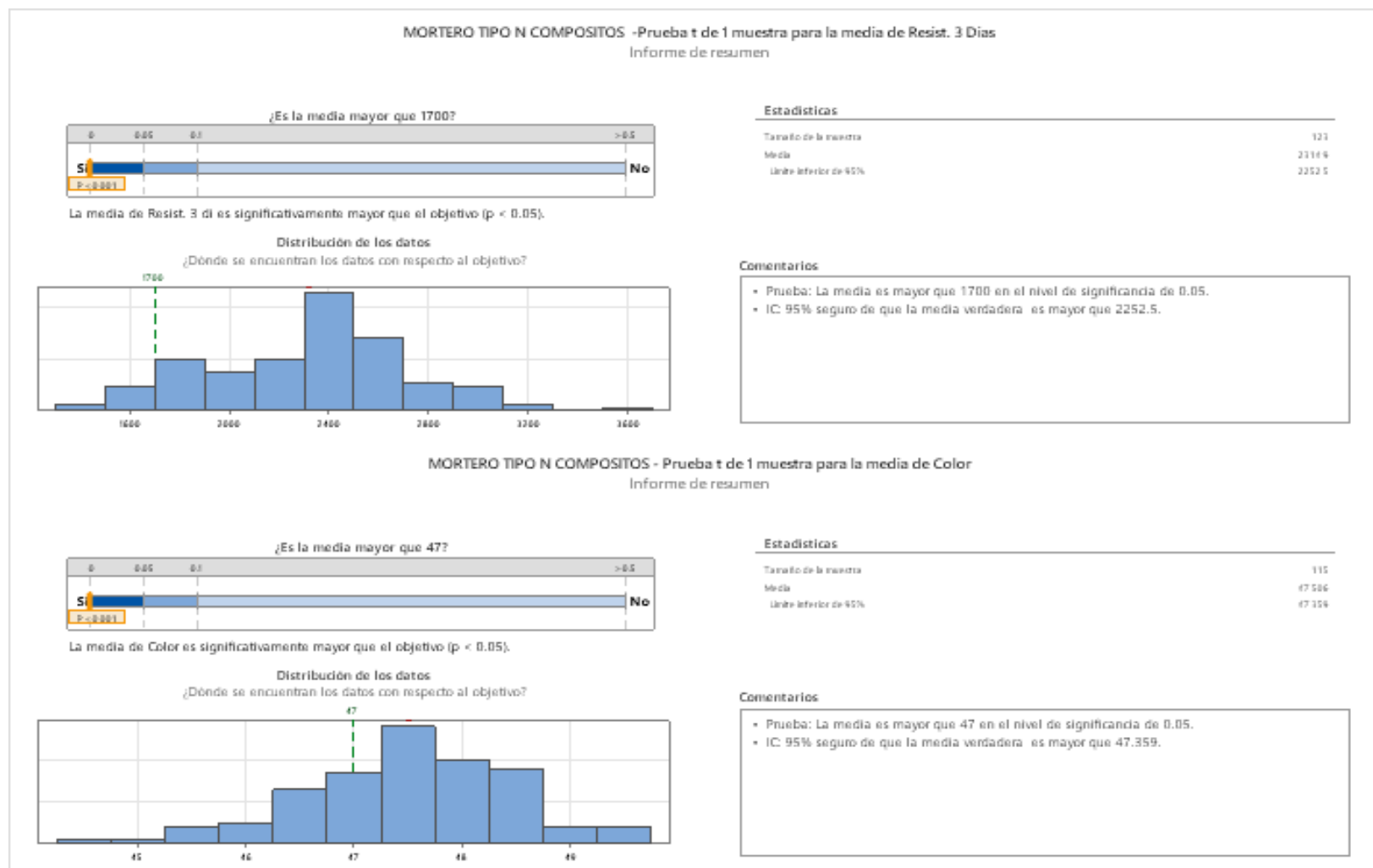
Figura 77. Resultados de pruebas de hipótesis para Resistencia y Color de Mortero Tipo N (Compositos)
