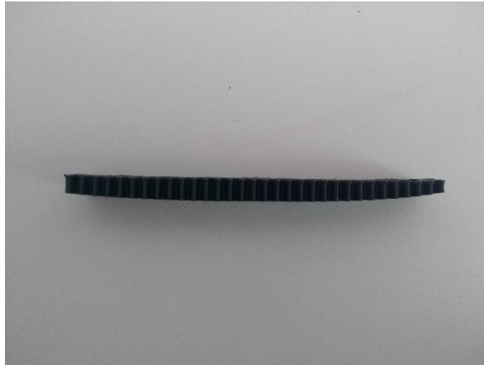
Imagen 3. Errores de impresión en cremallera impresa en ABS para pruebas.
