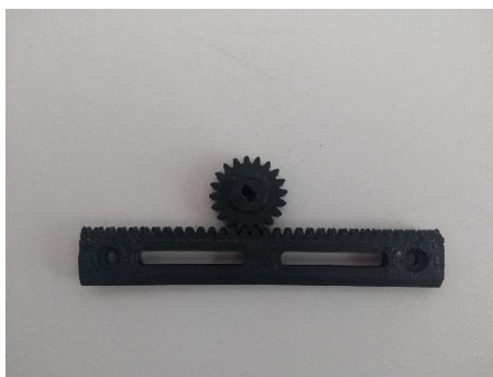
Imagen 2. Piñón y cremallera impresos en ABS para pruebas.
