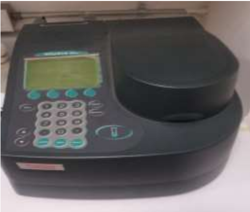
Figura 14. Espectrofotómetro UV-vis Genesys 10U en el laboratorio de óptica del Centro Universitario de Ciencias Exactas e Ingenierías de la Universidad de Guadalajara. Autoría Propia
