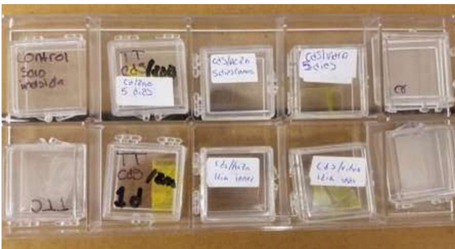
Figura 13. Sustratos de vidrio depositados con multicapas de ZnO Y CdS en almacenamiento individual según su tipo y orden de síntesis. Autoría Propia
