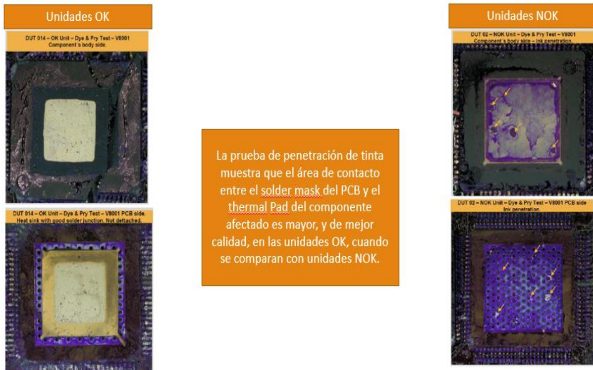
Imagen 2.8. Prueba de penetración de tinta
