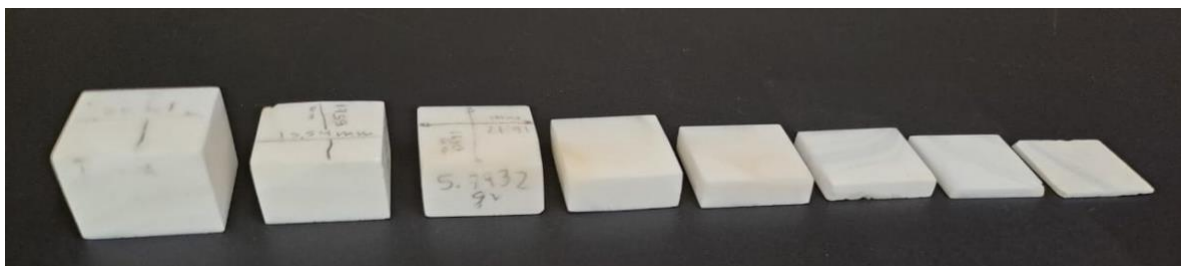
Figura 13. Estructuras calcáreas de Tridacna de espesores conocidos con posibilidad de ser utilizados como estándares para la calibración del medidor de espesor ultrasónico.
