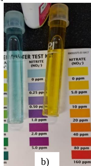
Figura 10. a) Reactivos para cada una de las pruebas analíticas: nitratos y nitritos. b) Las muestras se comparan con un tabulador colorimétrico para determinar concentración de los compuestos en partes por millón (ppm).
