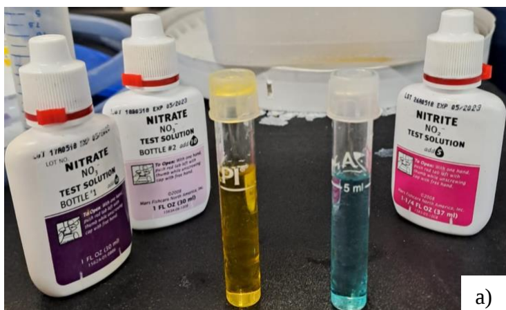
Figura 10. a) Reactivos para cada una de las pruebas analíticas: nitratos y nitritos. b) Las muestras se comparan con un tabulador colorimétrico para determinar concentración de los compuestos en partes por millón (ppm).
