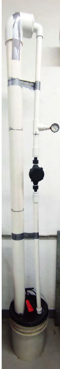
Figura 33. Prototipo funcional para determinar la atenuación natural de diversos contaminantes en los suelos del AMG.
