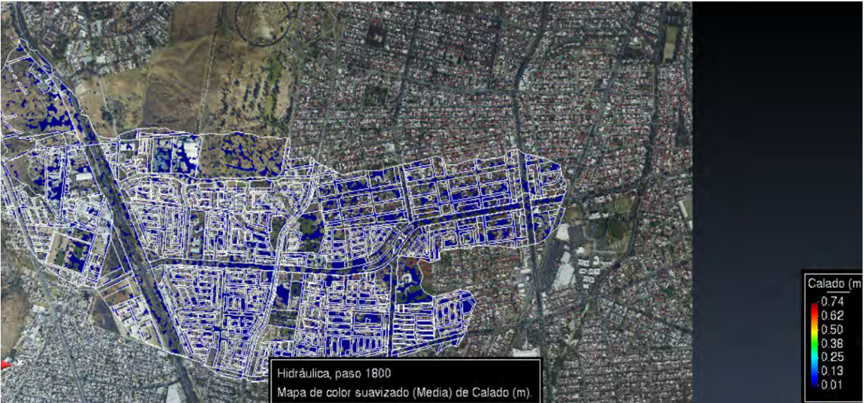
Figura 9. Resultados de calado del modelo hidrológico del canal de Tchaikovsky.
