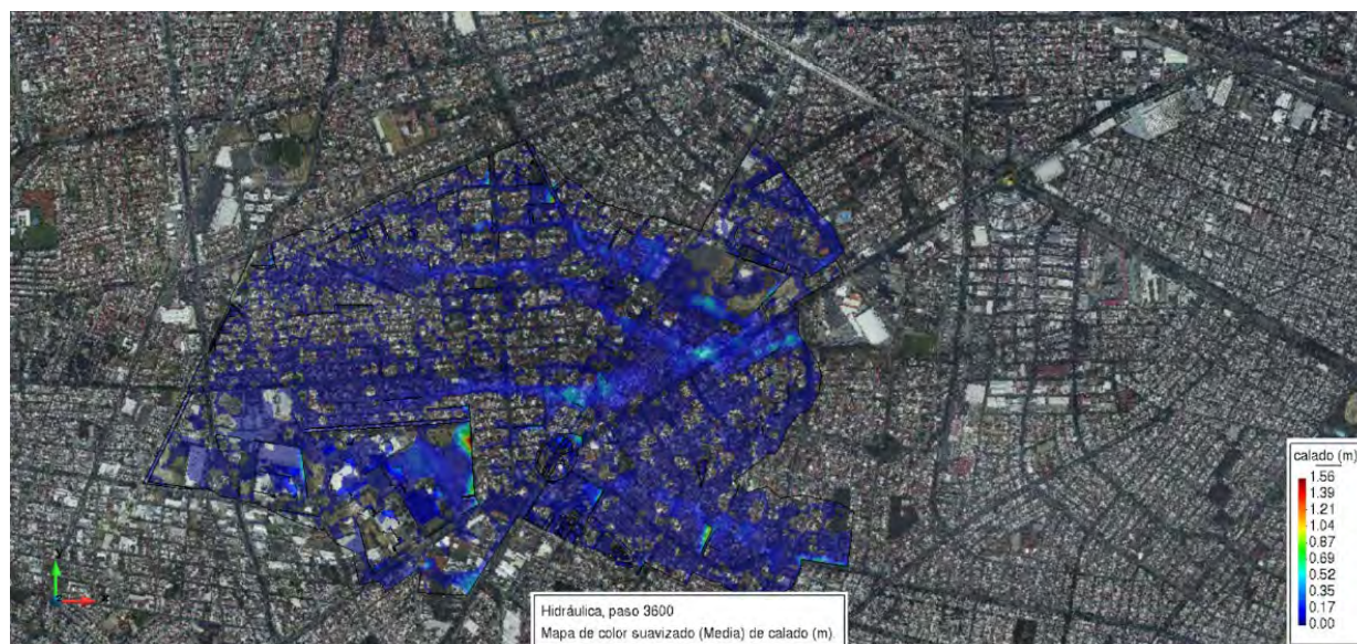
Figura 8. Resultados de calado del modelo hidrológico de cuenca de plaza del sol.
