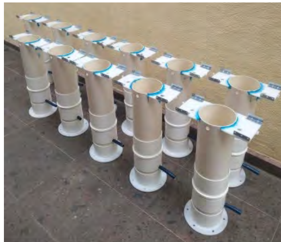
Figura 5. Pluviómetros terminados en aspecto mecánico.
